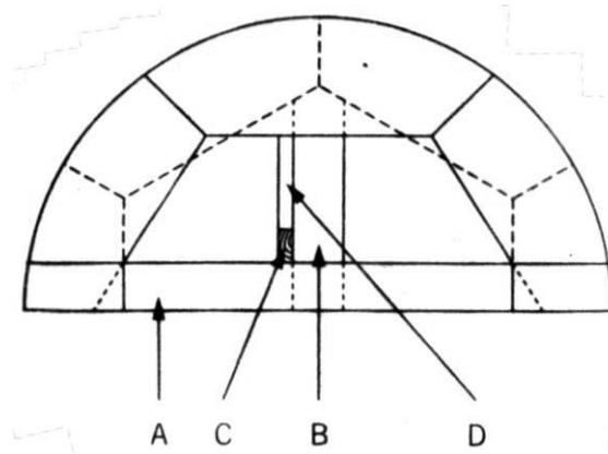
A – Bint B – Stut C – Horizontale spanstuk D – Diagonale spanstuk
