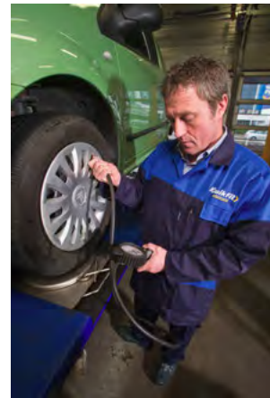
Die meting van die druk binne-in 'n band met behulp van 'n drukketer.
