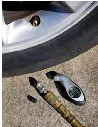
Twee ingewikkelde tipes banddrukketers vir die meting van banddruk. Die regterkantste een is 'n digitale meter.
