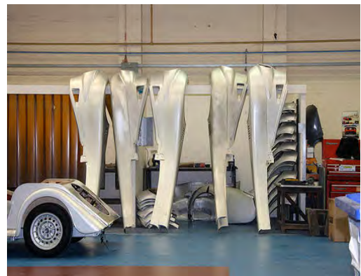
Kan jy sommige dele van 'n motor sien wat onderstebo in 'n motorfabriek hang? Dit word van metaalplate gemaak.
