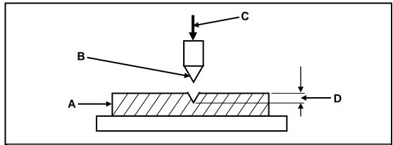
FIGURE 7.1: ROCKWELL HARDNESS TESTER
