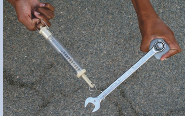
Figuur 4.21 Die trekskaal is aan die ring van die sleutel geheg, met die ander punt van die sleutel aan 'n moer.
