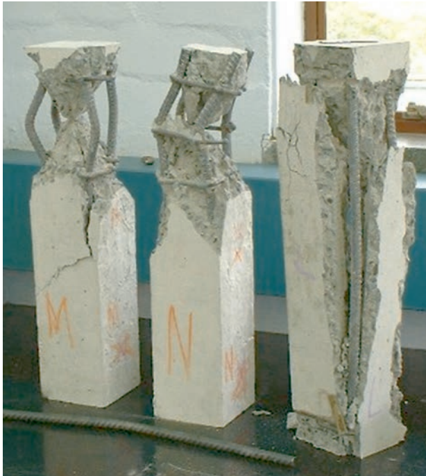
Figuur 3.21 'n Breuk as gevolg van kompressie in 'n betonpilaar. Die beton het weggebreek en die versterkingstawe het vervorm.
