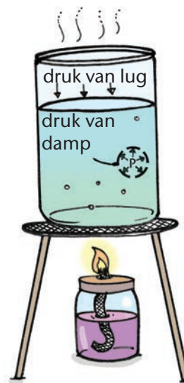
Figuur 11.7 Wanneer die lugdruk verlaag word, druk die lugmolekules nie die watermolekules so hard nie en die watermolekules kan makliker damp vorm.
