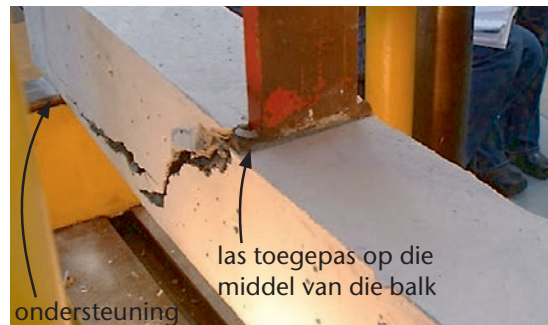
Figuur 5.24 Skuifkrake in 'n betonbalk – hulle begin by die steunpunt.
