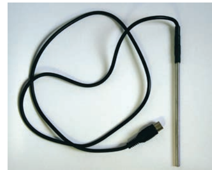
Figuur 16.11e 'n Temperatuur-sensor wat 'n termistor bevat.
