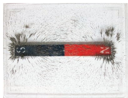
Figuur 3.13 Die magnetiese krag is 'n aantrekkings- of 'n afstotingskrag.
