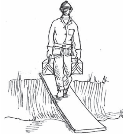
Figuur 5.12 'n 200 N puntlas op 'n eenvoudig-ondersteunde balk
