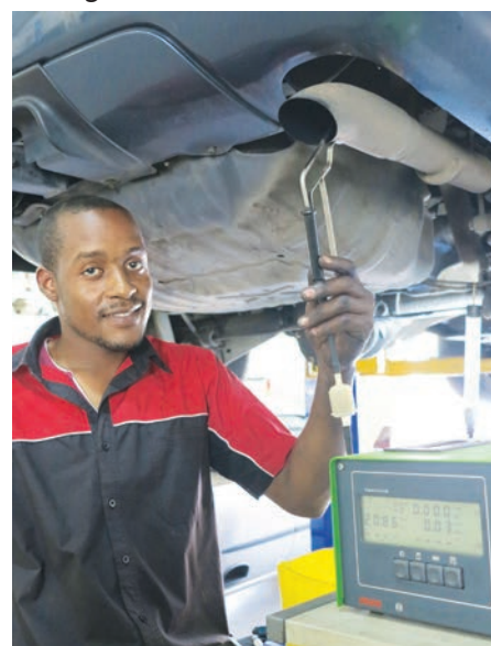
Figuur 9.7 Jy kan uitlaatgasse toets om die persentasie koolstofmonoksied in die gas te meet.
