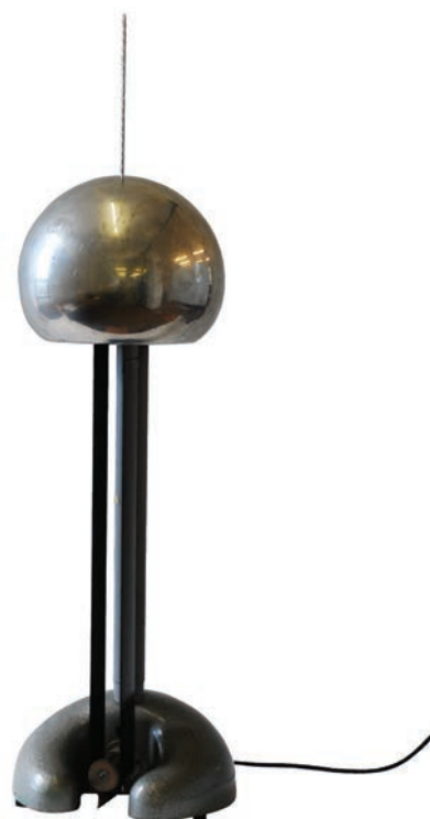
Figuur 12.21 Wanneer die weerligafleier bo-op die koepel is, kan elektriese ladings nie opbou nie.
