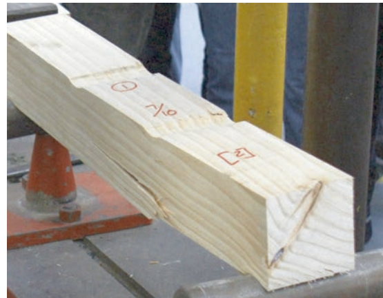
Figuur 5.31b Die vierkantprofiel-houtbalk toon falings in spanning aan die onderkant, klowing as gevolg van kompressie aan die bokant en skuifvlakke in die middel.
