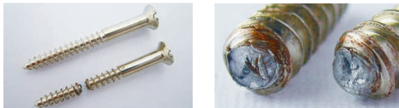
Figuur 3.30 Die twee vlakke van 'n skroef wat met wringing gebreek het
