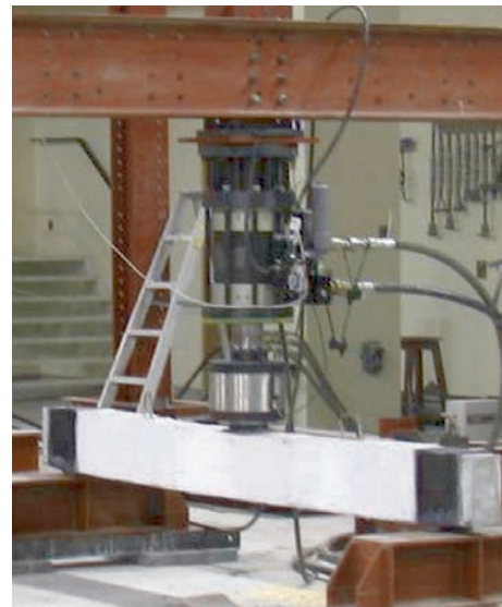
Figuur 5.4 Die betonbalk het by sy middelpunt gefaal.
